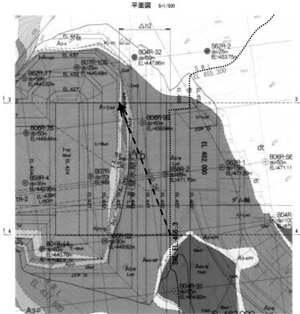
右岸側パイピング抵抗性検討 (I-w~A3-w間のはさみ層)
