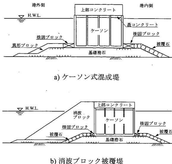
図-15 ケーソン式防波堤断面
