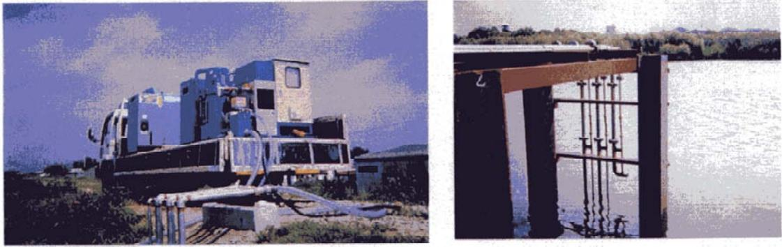
図－ 8.5 流砂捕捉ポンプ装置（左：ポンプ、右：採水口）
