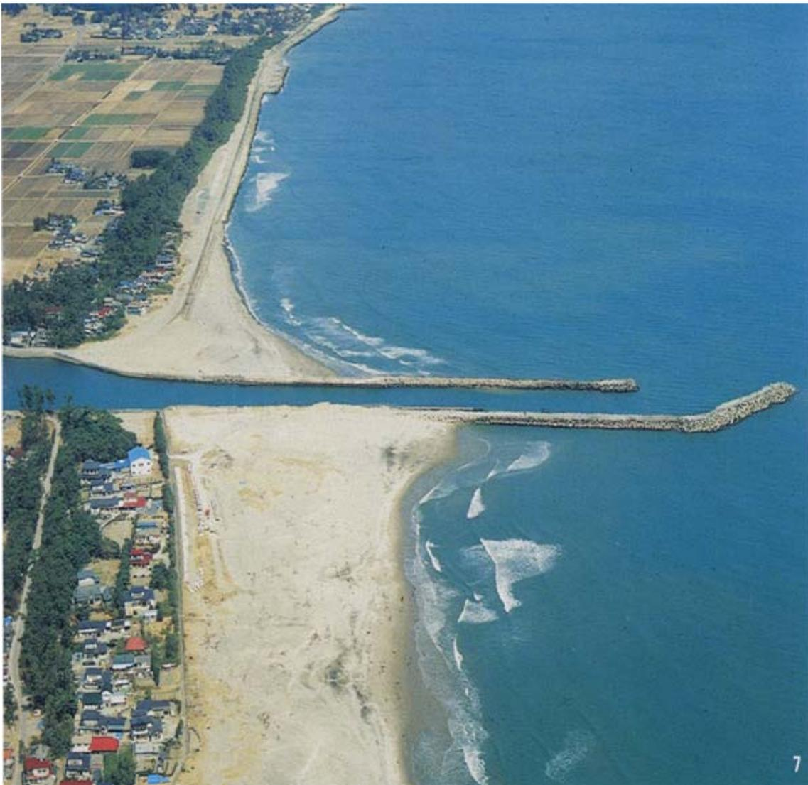
図－7.8 防波堤による漂砂の遮断（福島県真野川漁港周辺）
