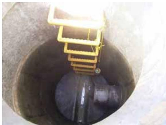
写真 4.8.1 拡散式硫化水素測定器の設置状況
