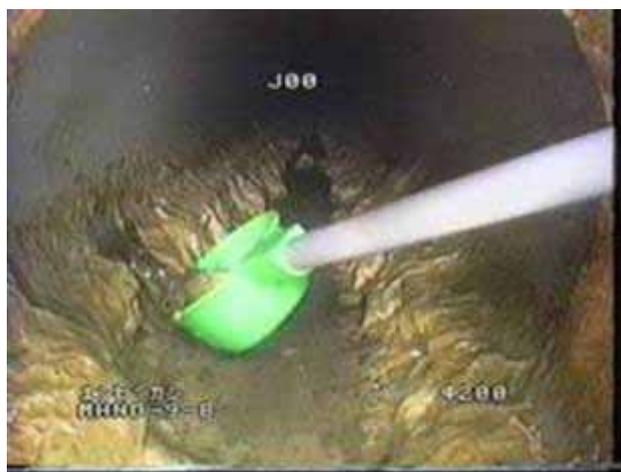
写真 4.3.6 管渠内付着物の採取状況
