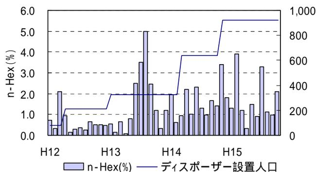
図 4.3.2 ポンプ場スクリーンし渣の n-Hex 含有率（下水処理場内ポンプ場）<sup>1)</sup>
