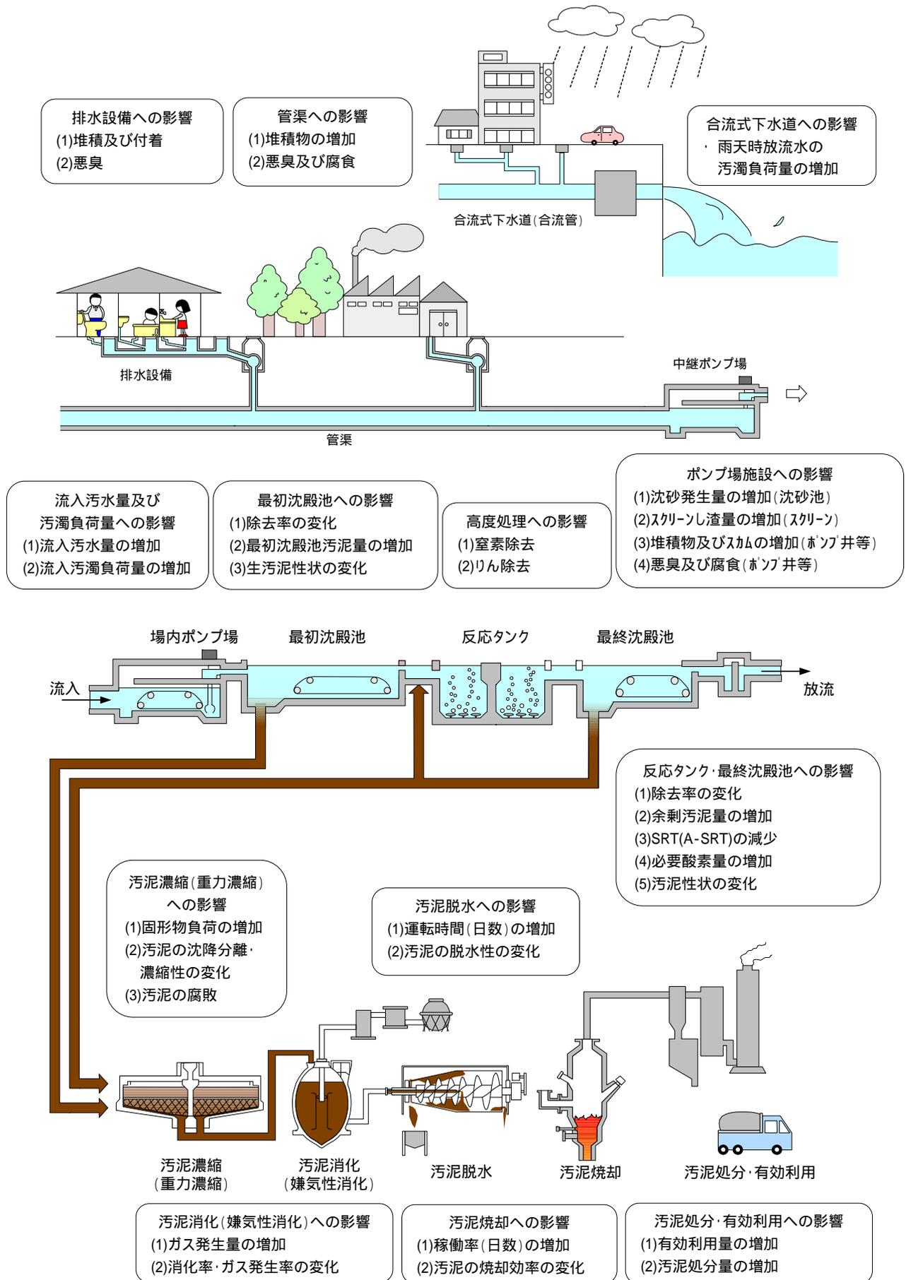
図 4.2 ディスパーザーを導入した場合に想定される下水道システムへの影響
