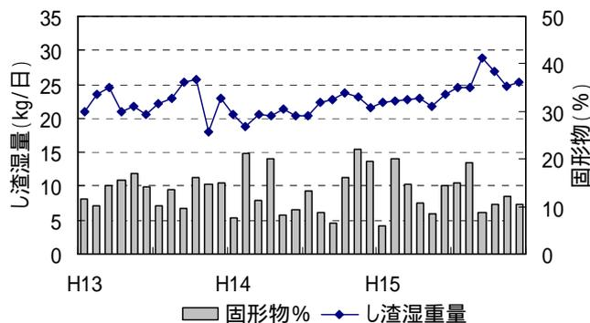
図 4.3.1 ポンプ場スクリーンし渣湿潤重量と固形物含有率 ( 中継ポンプ場及び下水処理場内ポンプ場 )<sup>1)</sup>
