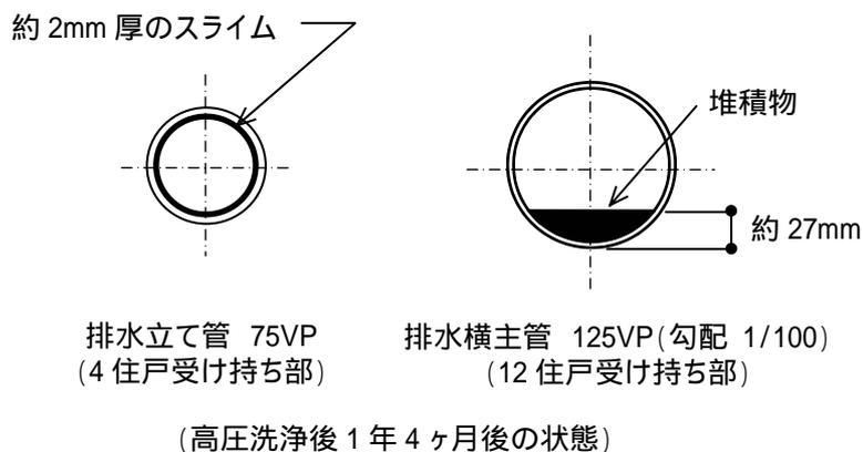
図 4.1.3 ディスポーザー排水処理システムでの排水管内の付着物<sup>3)</sup>
