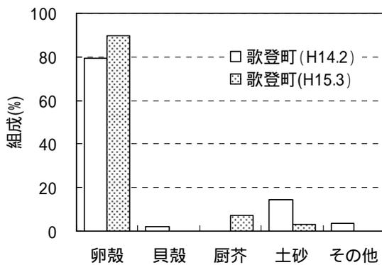
図 4.2.1 ディスポーザー設置地区の管渠内堆積物組成<sup>11)</sup>
