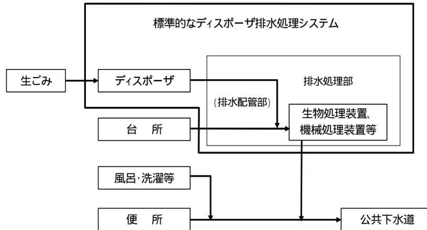
図 1.2.2 ディスポーザ排水処理システム<sup>9)</sup> (一部修正)
