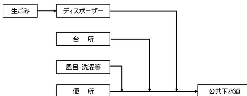
図 1.2.1 直接投入型(単体)ディスポーザー
