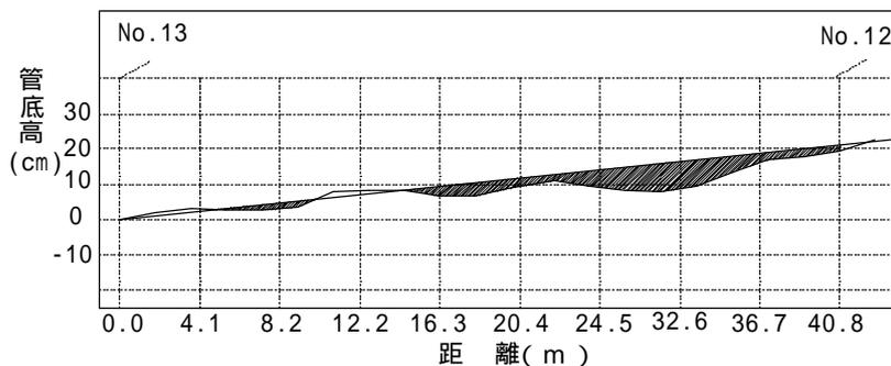
図 4.2.2 管渠底高のたわみ部分の堆積状況（歌登町）<sup>11)</sup>
