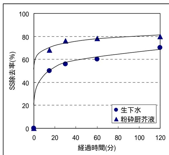
図 4.5.3 沈殿時間と SS 除去率<sup>39)</sup>
