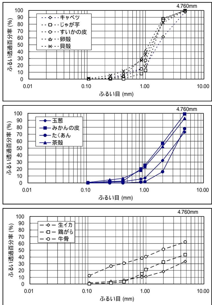
図 4.3.4 ディスパーザー排水中固形物の粒径分布<sup>12)</sup>
