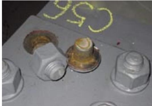
写真-4.8 ボルトが折損した例
