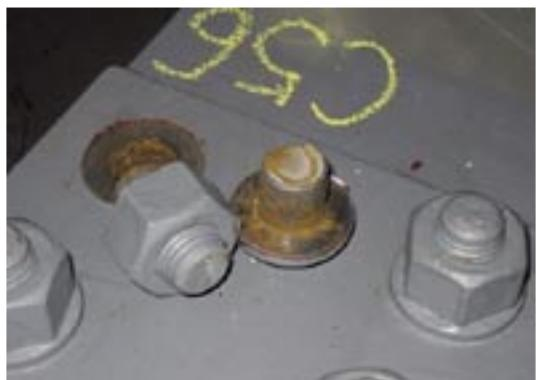
写真-3.3 ボルトが折損した例
