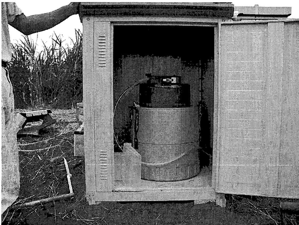
写真-2.2.3 自動採水器設置状況
