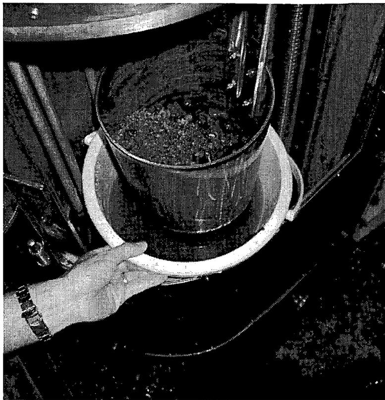
写真-2.2.2 掃流砂量採取状況
