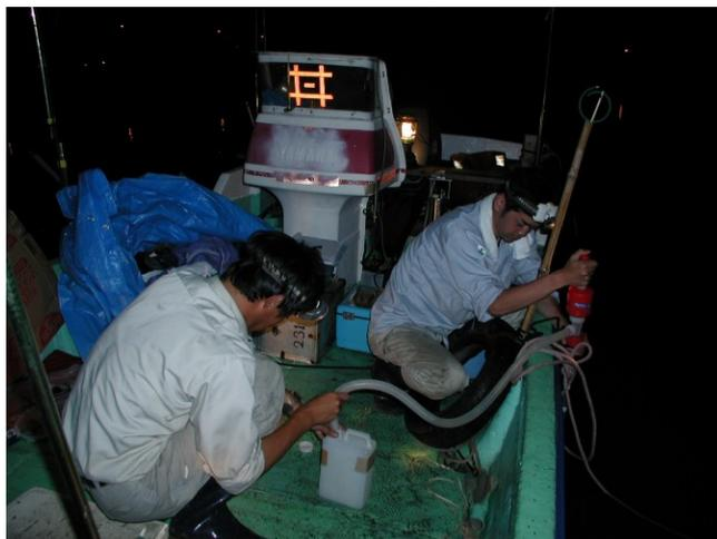
写真－6－5 手動ポンプによる高濁度水塊からの採水
