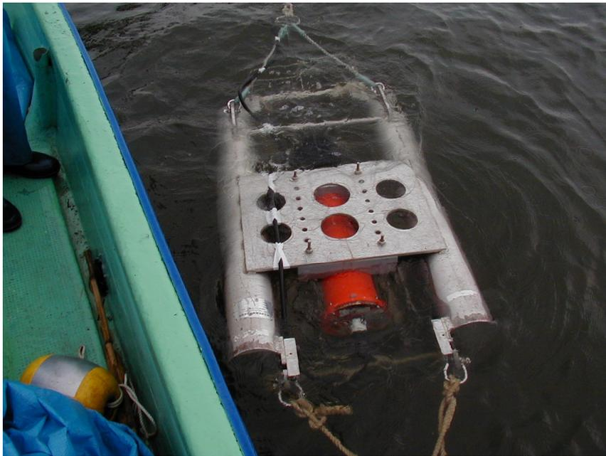
写真-6-8 曳航式 ADCP と浮体
