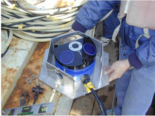
写真-2-2 (a) 超音波流速計 (Narrow Band Type : 1.5MHz, 有線式)
