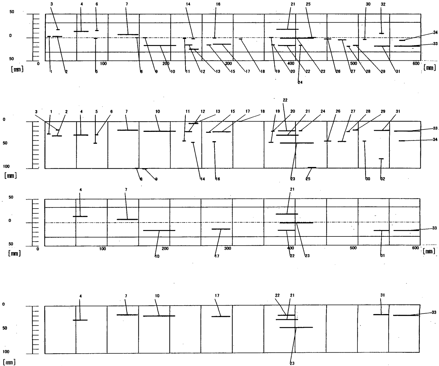
図-7.2.1 (h) 回送試験体のきずの位置 (1005試験体)
