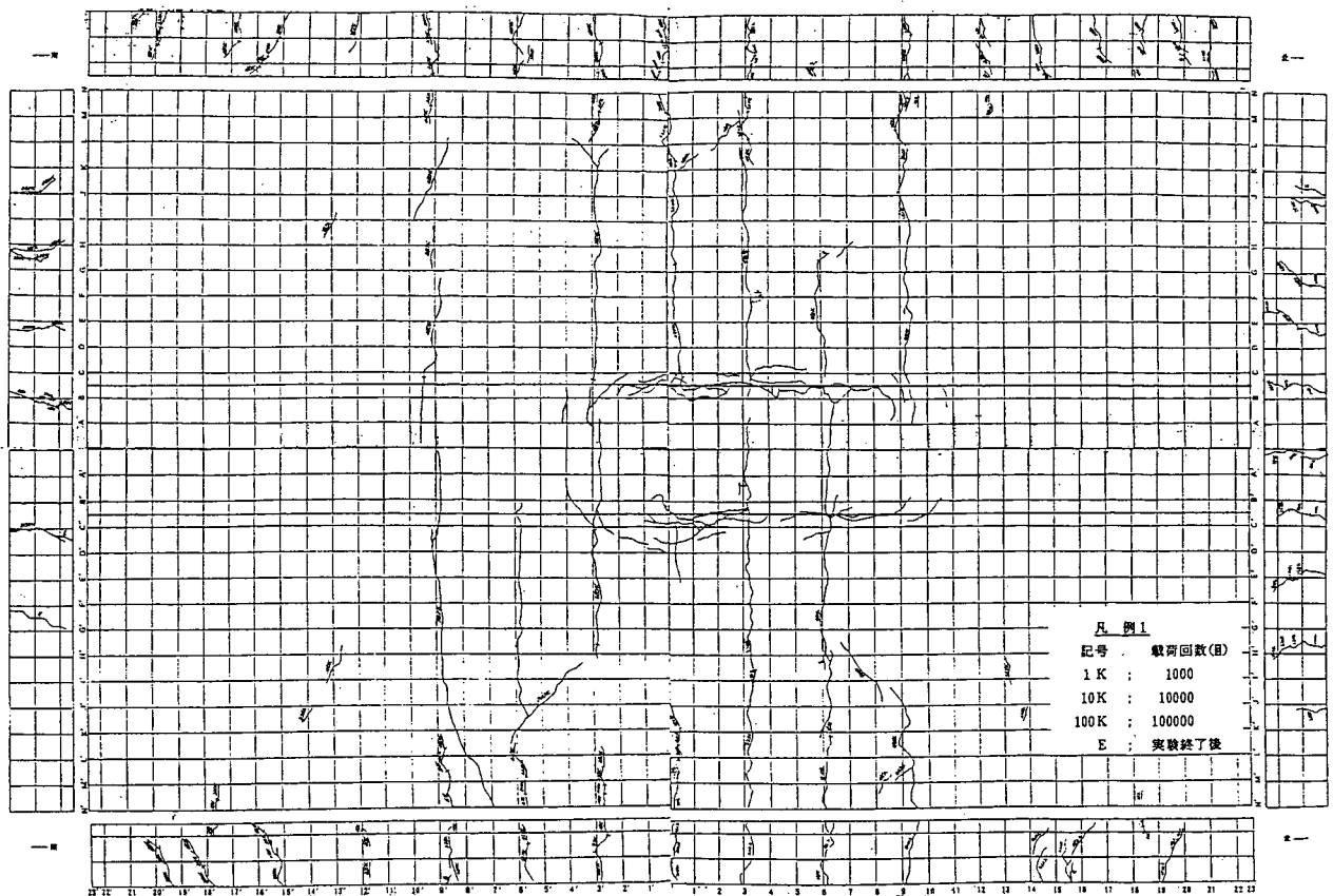
付図-7.17.1 RC8n-1 供試体のひび割れ状況（床版上面）
