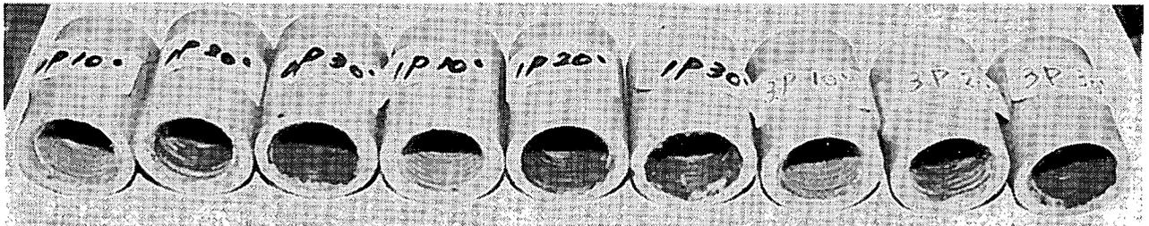
写真-1 浸漬実験後の铸铁ソケット（ラベル数値は塩素濃度と温度）
