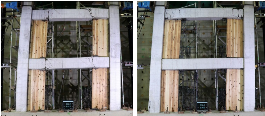
図 3.1 RC+CLT 袖壁の架構実験
