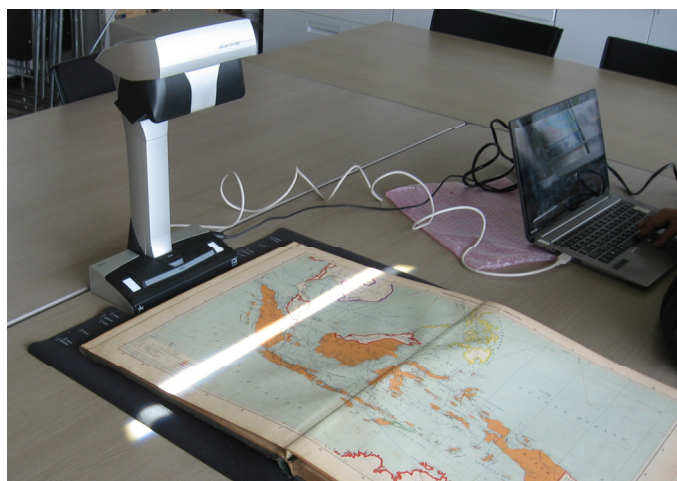
写真 4-7-4 オーバーヘッド型スキャナによる古い地図のスキャン
