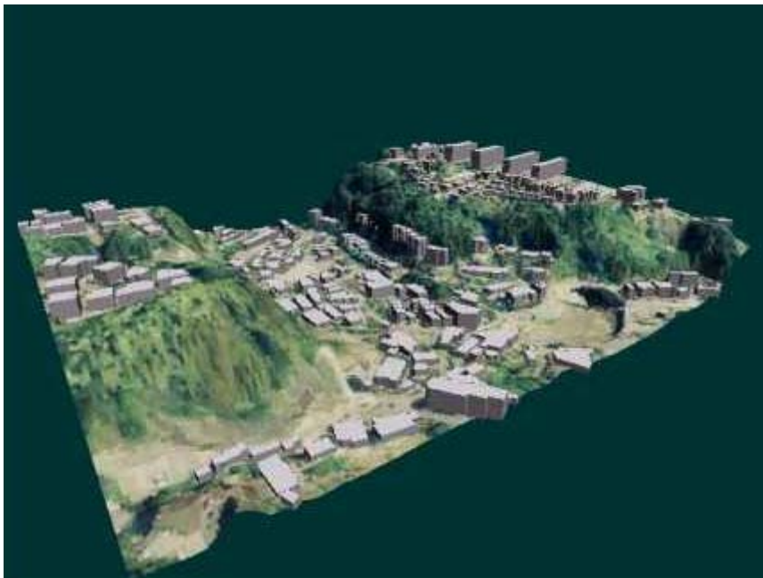
図 2-3-7 ステレオ空中写真から復原した地形 (広島,2001)
