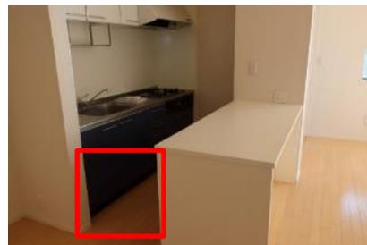
写真Ⅱ.33 キッチン入口のチャイルドフェンスを設置することのできる配慮（両側は木製の壁、カウンターとする）
