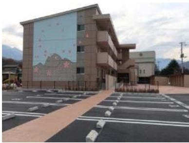
写真Ⅱ.82 仕上げの色で視覚的にも車動線と分離して設けられた歩行者動線
