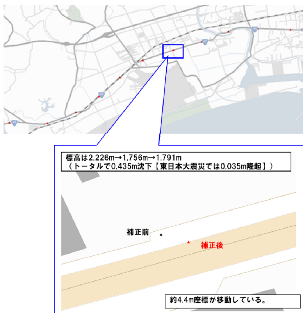
図-3.3.14.12 道路基準点の座標補正例
