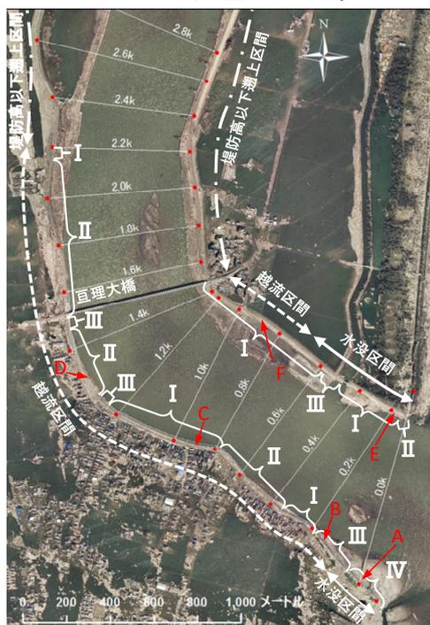
写真-3.3.3.1 津波痕跡水位と堤防高との関係及び被災状況（航空写真は国土地理院による撮影データ）
