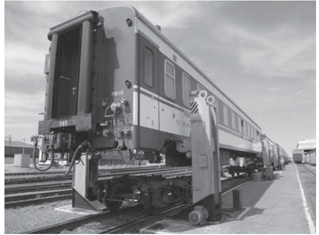
写真 A14-4 台車を外され ジャッキで持ち上げられた客車
