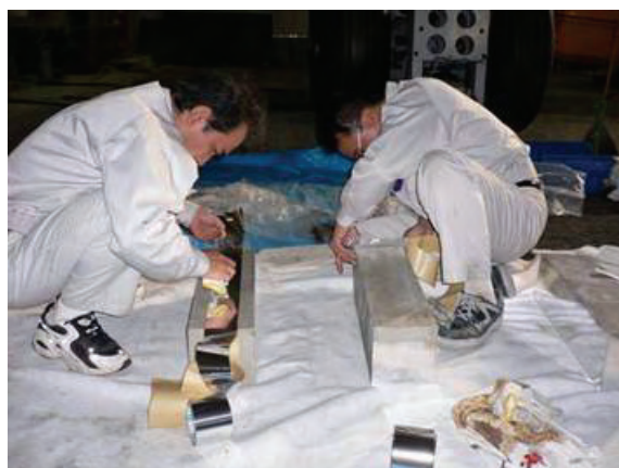
写真-6.3.2 アルミシート被覆，測定用チップ接着状況
