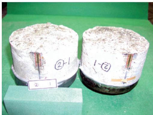
(a) 界面での破壊 (②工区)
