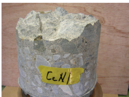
(c) 既設コンクリートでの破壊 (C-N 工区)
