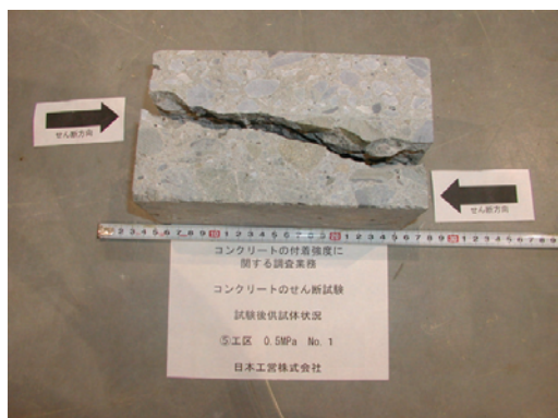
(b) 斜め破壊 (⑤工区)
