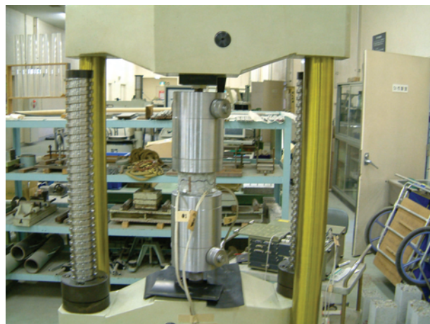
写真-4.4.1 付着試験状況
