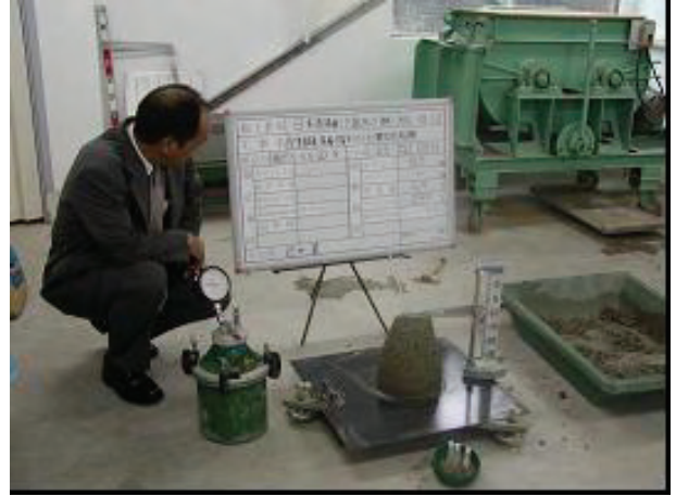
写真-4.2.1 SFRC の試験練り
