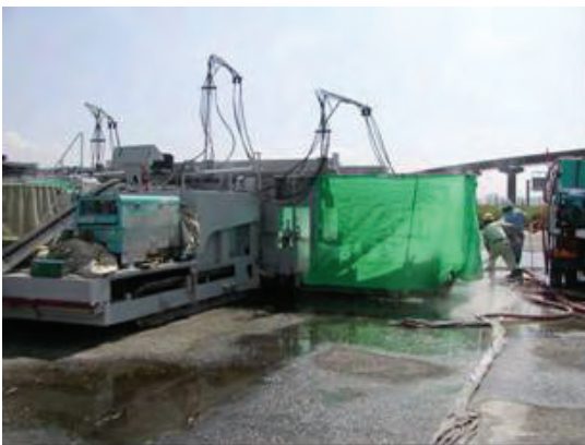
写真-4.2.3 WJ処理機械（前から）
