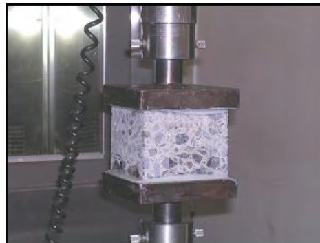
写真-3.2.6 引張接着試験状況
