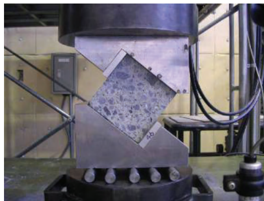
写真-3.2.5 せん断試験状況
