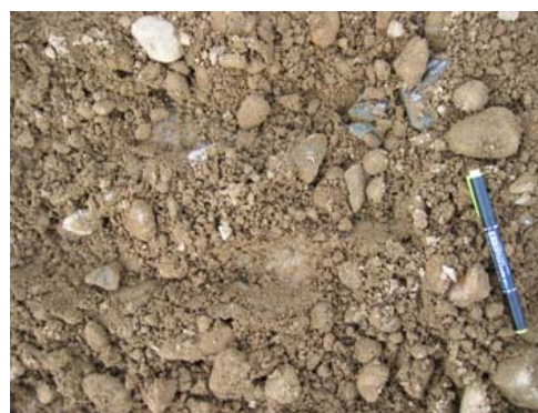
写真-7.16 フィルター材 (新山本調整池)
