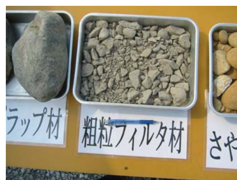
写真-7.22 粗粒フィルター材 (山本調整池)
