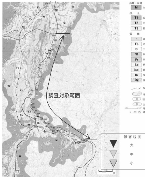
図-8.3.4 国道17号盛土の被害分析対象箇所
