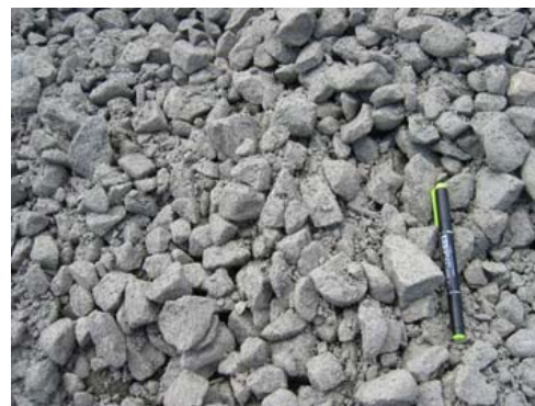
写真-7.8 粗粒フィルター材 (浅河原調整池)
