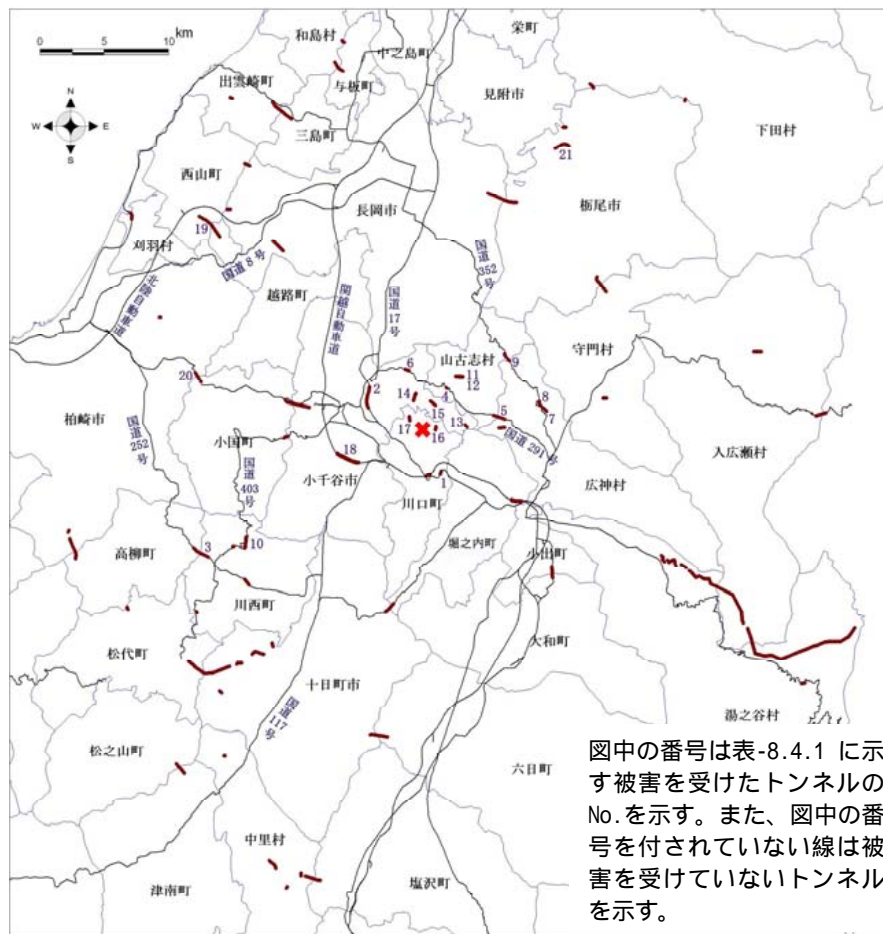
図-8.4.1 被害が発生したトンネル位置図
