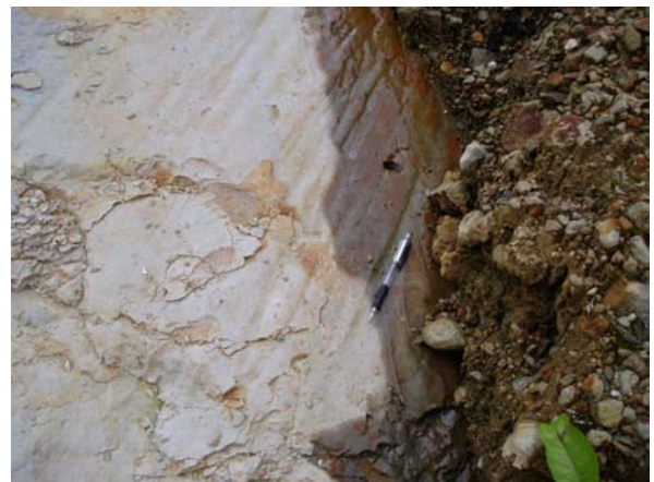
写真-4.11 すべり面に見える擦痕
