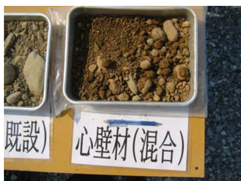
写真-7.21 心壁材料 (コア材料) (山本調整池)
