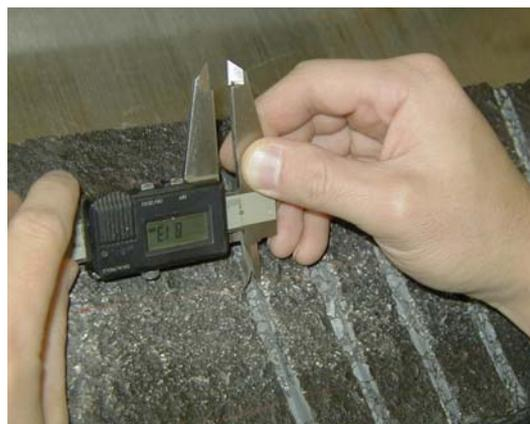
写真-3 溝幅の測定
