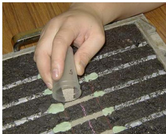
写真-2 グルーピングの溝の容積測定状況
