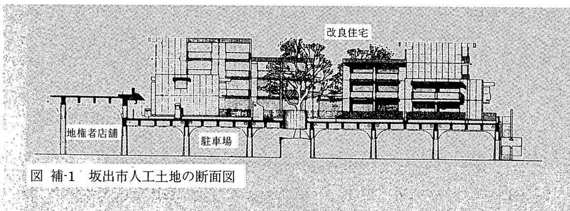
図 補-1 坂出市人工土地の断面図
