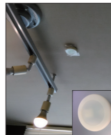
iBeacon本体(右下)と天井に設置している様子
