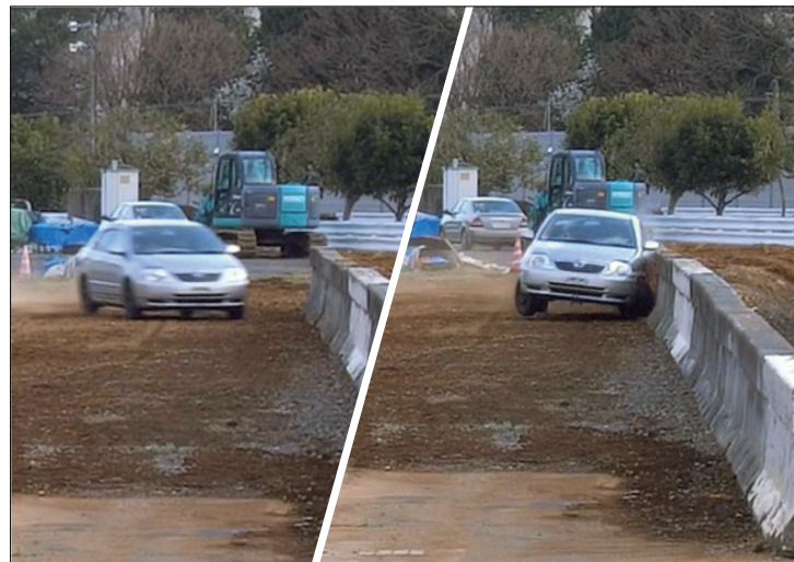
写真 防護柵の実車衝突実験 実車両を牽引装置の動力により無人乗車で加速し、所定の衝突速度・角度で防護柵に衝突させ、防護柵の性能を評価します。
