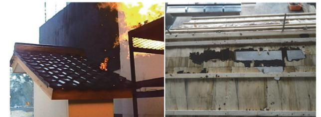
写真1 火の粉による出火実験 写真2 屋根下地の燃え抜け例
