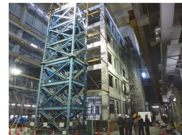
写真 実大5層建築物の損傷実験
