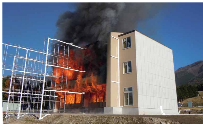
1 階と 2 階に火災が拡大した点火後 137 分時点の様子
