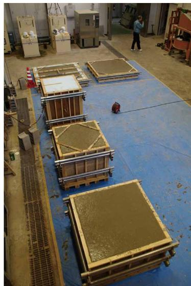
写真 1 作製中の実大試験体
