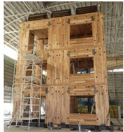
CLT パネル構造試験体
