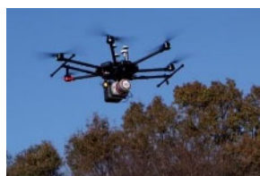
大型ドローンはレーザ計測器の搭載も可能
