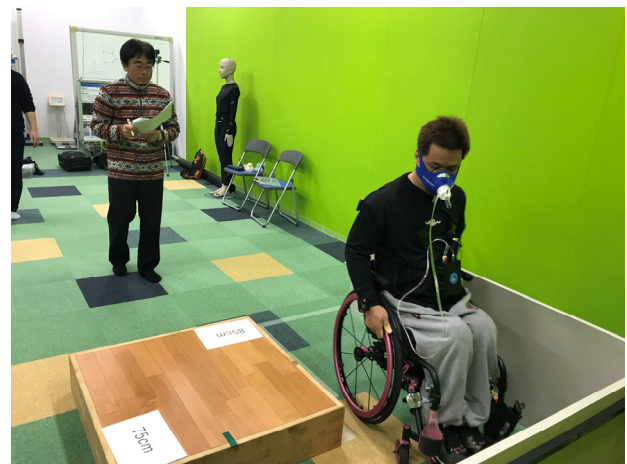
図 1 生活行為における身体活動量の計測 (車いすでの移動について呼気代謝計を用いて計測)
