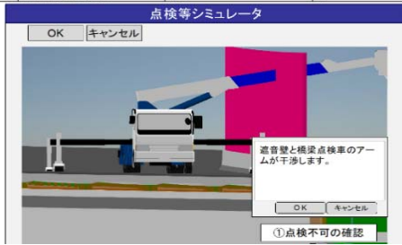
図-1 点検シミュレーションの適用事例のプロトタイプ部の画面（点検車両の干渉確認）
