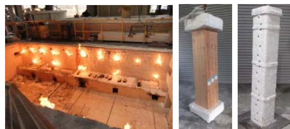
a) 耐火炉の燃焼状況 b) 木部材 c) 鋼部材
