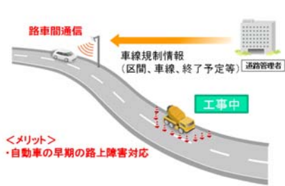
図-2 車線規制（路上障害）情報の提供
