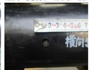
図-3 円孔損傷ケース
