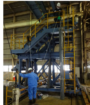
図-7 浸水試験装置
