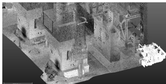
図-1 排水機場原動機室点群データ表示例
