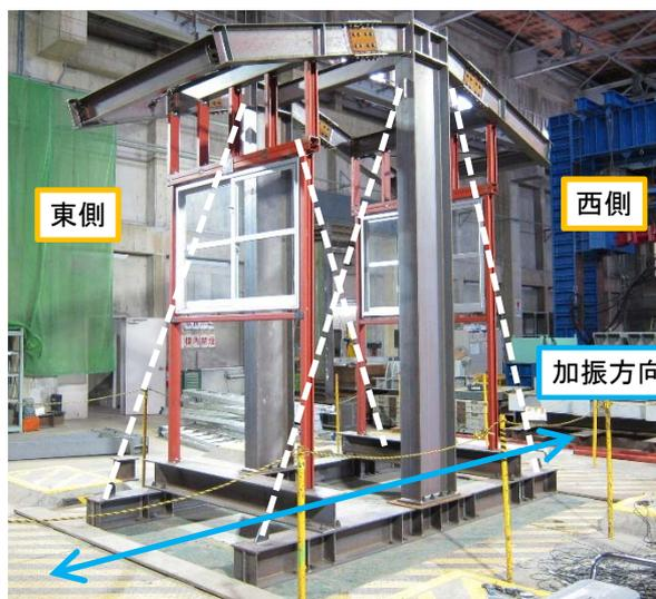
図-2 試験体全景 (白破線がブレース設置箇所)
