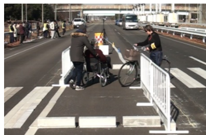
図-2 交通島でのすれ違いの通行実験
