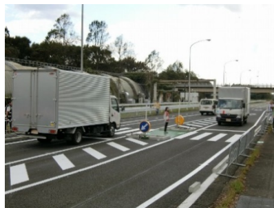
図-1 二段階横断施設の幅員構成の走行実験
