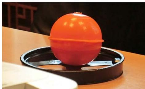
図-4 地下埋設物件の探知技術 (IC タグ)
