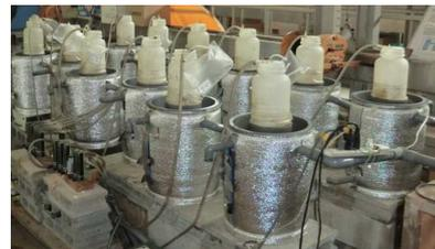
写真-1 水処理プロセスのベンチスケールリアクター
