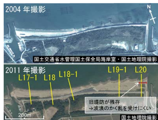
写真-1 伊勢湾西南海岸北藤原工区と測線配置
