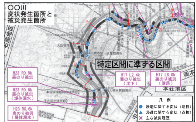
図-5 被災発生箇所と変状発生箇所の比較
