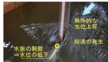
写真-1 鋼管を模したアクリルパイプ周辺の水位状況
