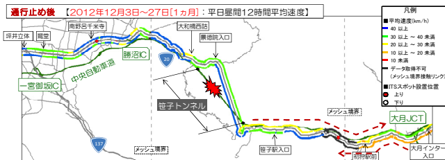
図2 道路プローブデータの活用事例 (中央道笹子トンネル通行止め時の交通状況の把握)
