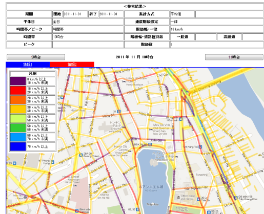
図 4 試作したプローブ活用パッケージの表示画面例(速度ランク図作成機能)
