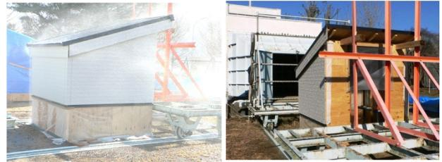
写真1 強風雨撒水実験状況例 (風速 20m/s)
