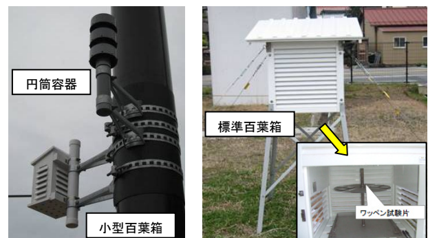
写真-1 簡易架台を用いた曝露試験
