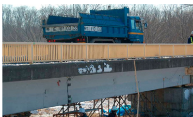
写真-1 載荷実験により健全性を評価している事例
