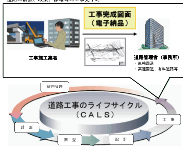
図-1 道路工事における完成図の電子化
